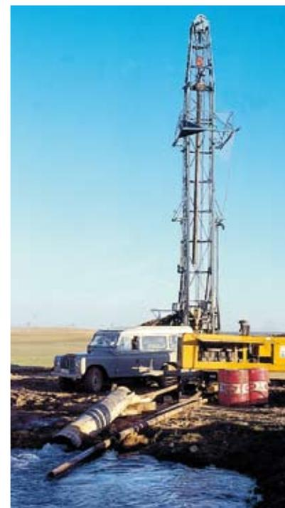
*Perforación de un pozo por el sistema de rotación con circulación de lodos*
