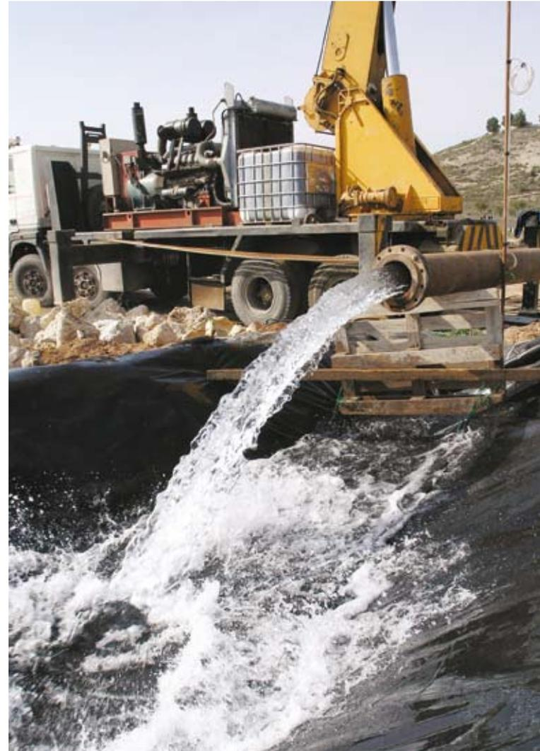
**Equipo de ensayo de bombeo**
