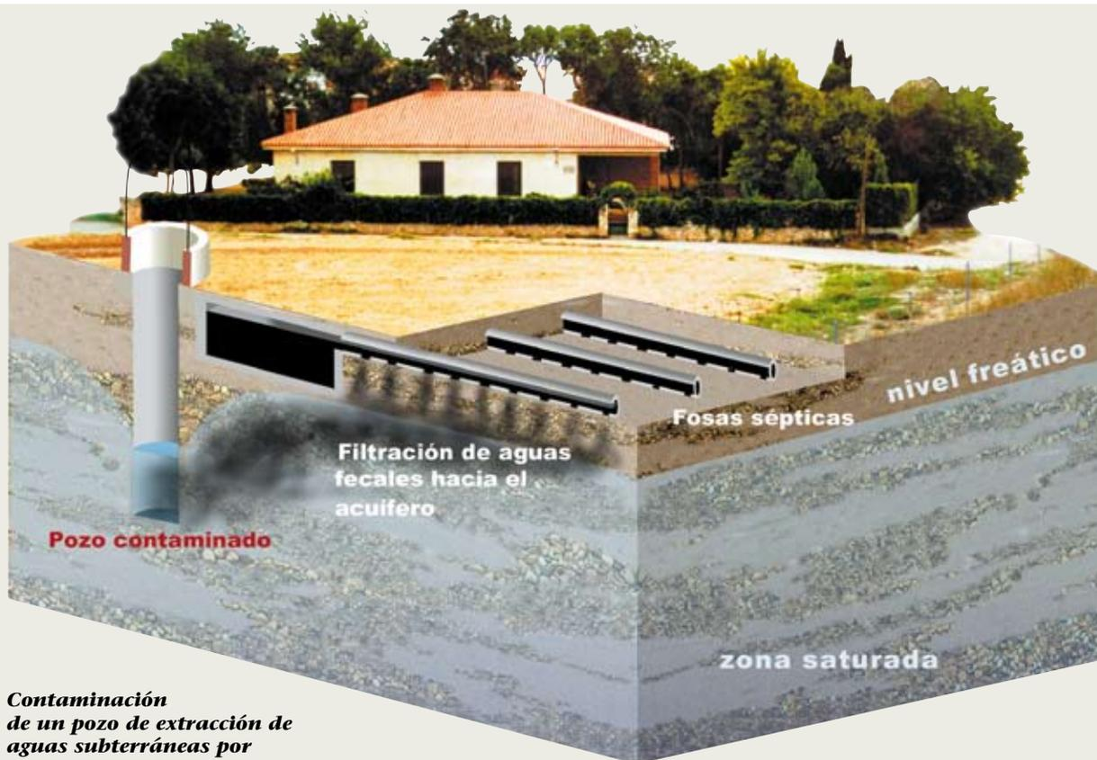
**Contaminación de un pozo de extracción de aguas subterráneas por efecto de una fosa séptica**
