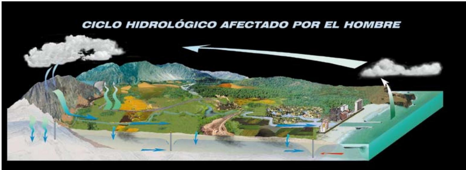
*Este esquema representa cómo es afectado el ciclo hidrológico por la intervención del hombre: contaminación atmosférica, contaminación y disminución de los caudales circulantes por los ríos, descenso de los niveles piezométricos y avance de agua de mar en los acuíferos (flecha roja)*
