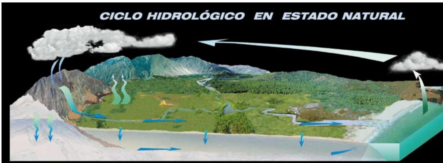
Esquema que representa las diferentes fases del ciclo hidrológico: evaporación del agua de mar, transporte como nubes, precipitación (niebla, lluvia o nieve), escorrentía por ríos y arroyos, recarga de acuíferos, evapotranspiración, salidas al mar y de nuevo inicio del ciclo
