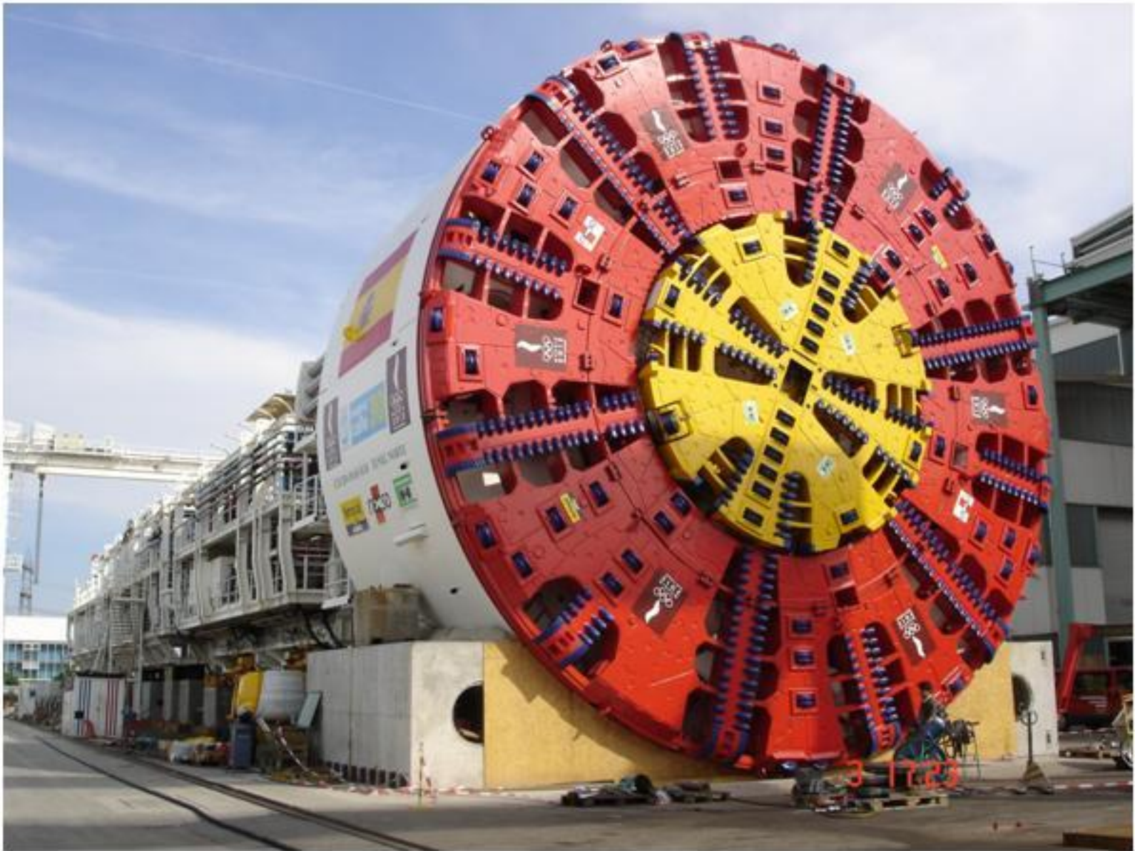
TUNELADORA BY-PASS SUR / TÚNEL NORTE DULCINEA
