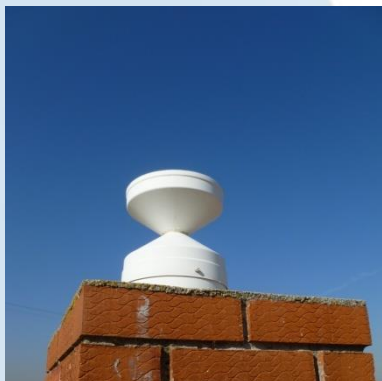
Precipitación Pluviómetros ARG100 y RM52203
